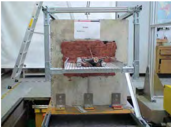
Testaufbau mit CP 620 – Kabeltrasse.
