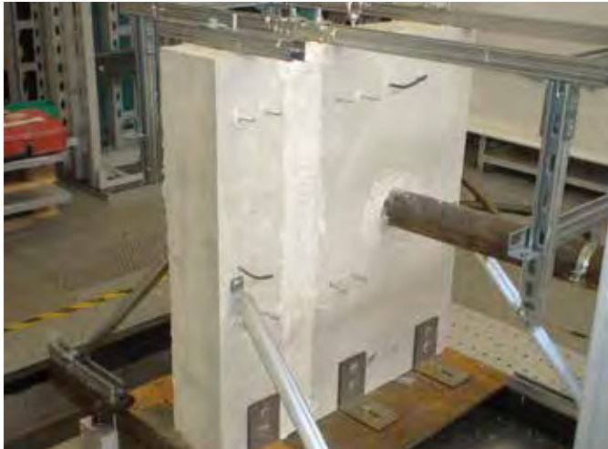
Betonrahmen: 1000 mm hoch, 900 mm breit, 200 mm dick. Aufhängung: Gebaut mit Hilti MQ 21 D System.
