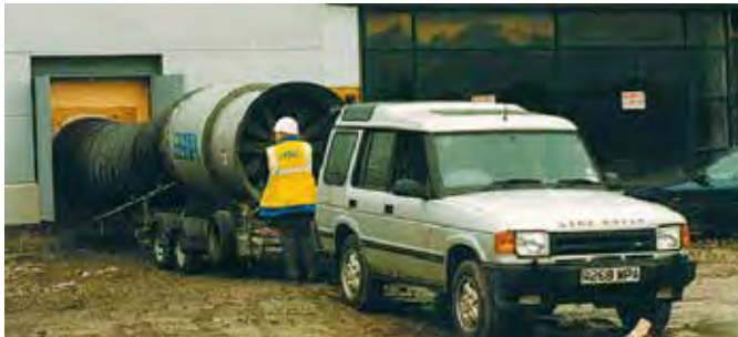
„Blower door test“
