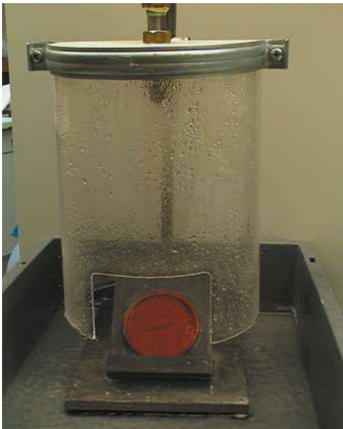
Versuchsaufbau Brandschutzfugenspray CP 672.
