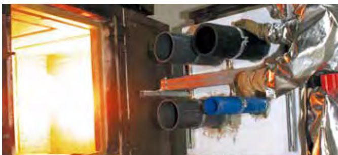
Brandtestofen im Hilti Forschungs- und Technologiecenter.
