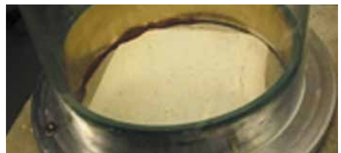
CFS-S SIL mit Flansch und Plexiglasrohr montiert.
