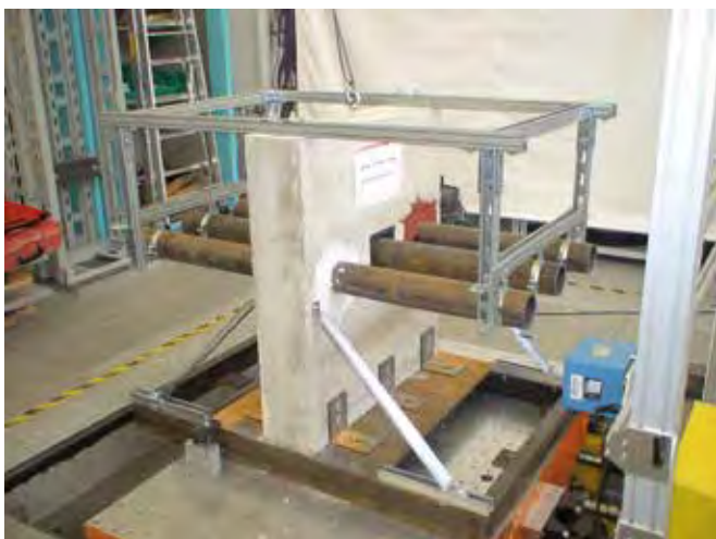
Testaufbau mit CFS-S ACR – Stahlrohr.
