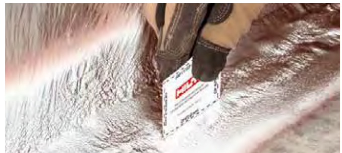
Überprüfung der Dicke des Nassfilms.
