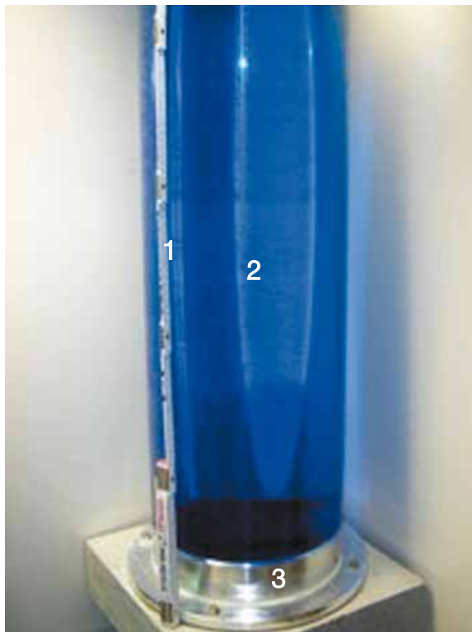
Bildbeschreibung 1 1 m Wassersäule 2 Wasser (gefärbt) 3 Probekörper
